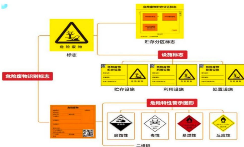
图 4-3 危废暂存间标识牌设置
