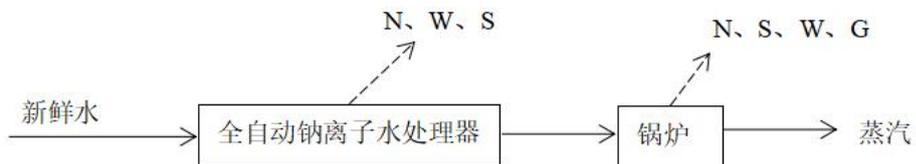
图 2-5 软水制备生产工艺流程图
